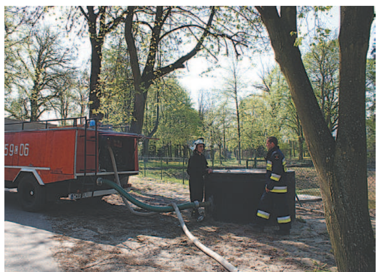
Sprawdzali czy nie ma problemów ze studnią czerpną, która umożliwia zasilanie pojazdów pożarniczych w wodę
