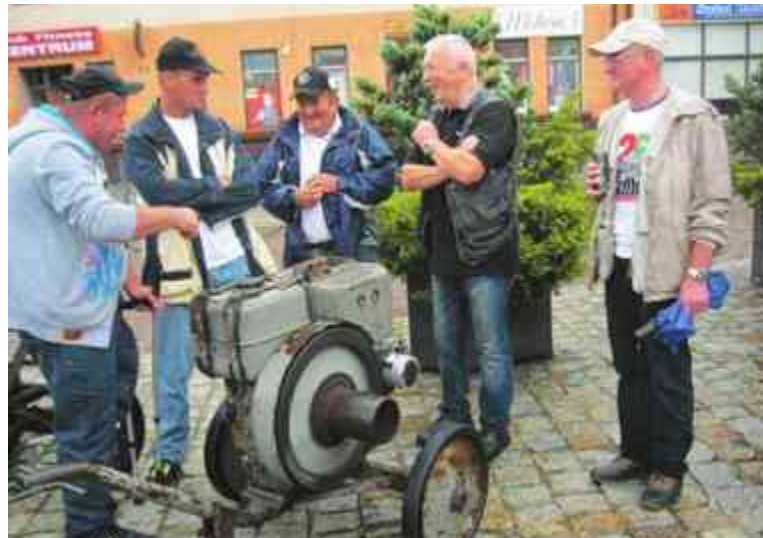
Silnik stacjonarny do napędu m.in. młockarni, siewczarni, śrutownika i piły tarczowej wzbudzał zainteresowanie oglądających wystawę
