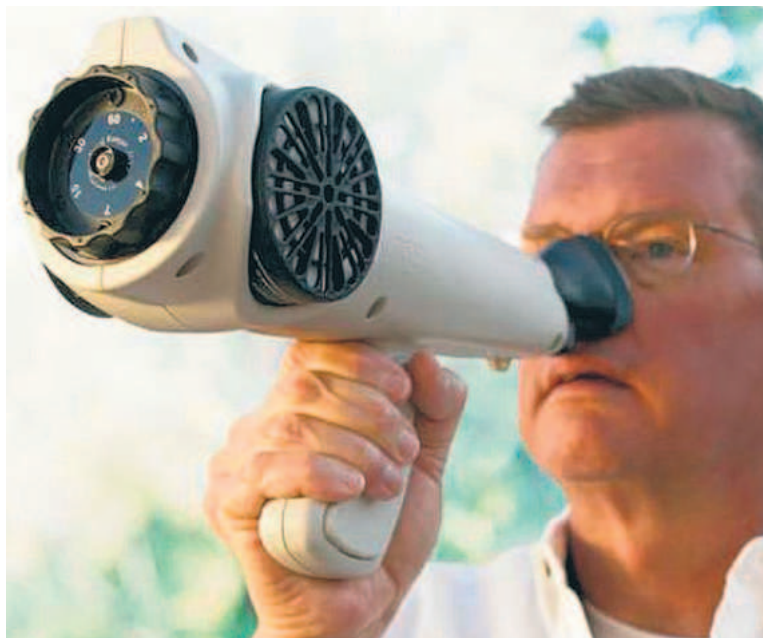
Takie podręczne, a raczej podnośne, urządzenie posłuży badaniu natężenia smrodu
