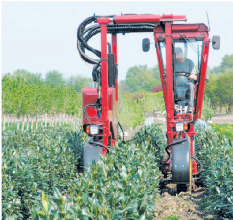
Traktor szczudłowy – narzędzie do walki ze stonką
