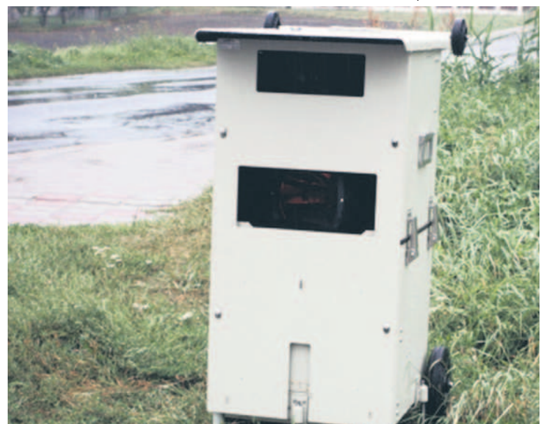
Fotoradar Multanova 6F wykonuje pomiary zarówno nadjeżdżających jak i odjeżdżających pojazdów. Urządzenie może mierzyć prędkość w nocy oraz w złych warunkach świetlnych czy też atmosferycznych.
