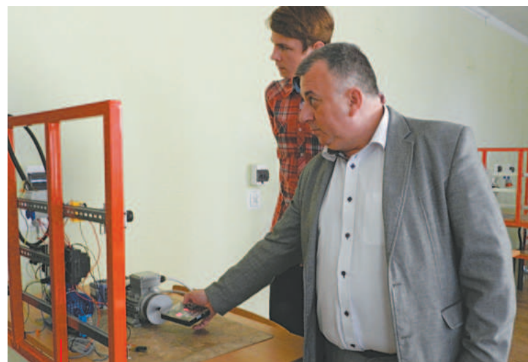
Dyrektor Tomasz Wilamowski podpowiada, jak wykorzystując zjawisko stroboskopowe można zmierzyć prędkość obrotową silnika
