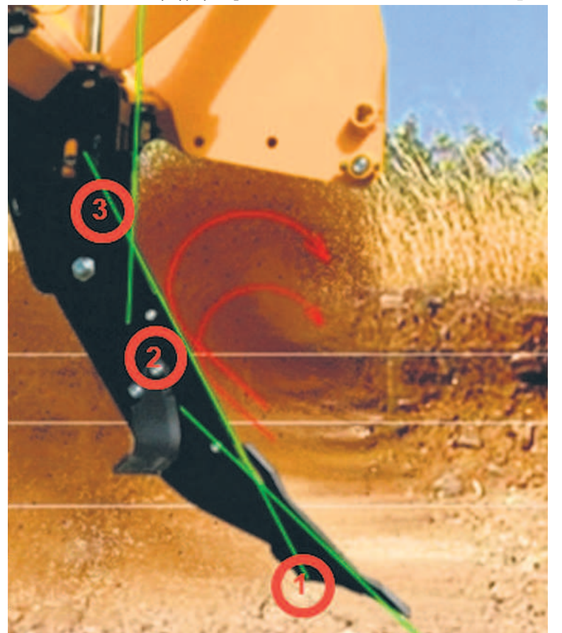
Zasada działania pługu zębowego
